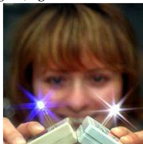
Hình 8: Đèn phát huỳnh quang màu xanh (trái) và màu trắng (phải) được chế tạo tại Sandia National Laboratories (Mỹ).
