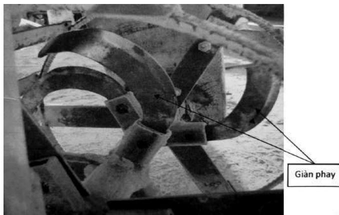
Máy được sử dụng để phay đất
