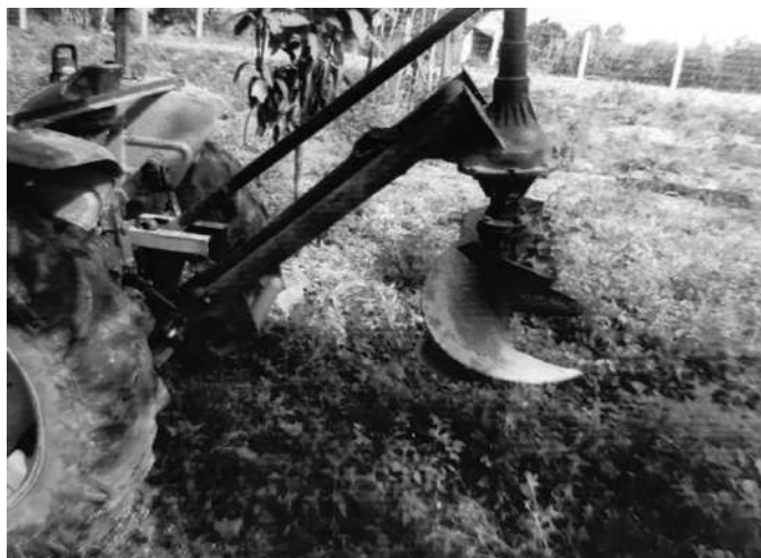
Giàn khoan hố trồng cây được gắn sau máy cày
