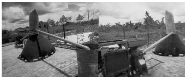
Hình ảnh thiết bị buồng tách, lọc bụi vỏ cà phê đang hoạt động
